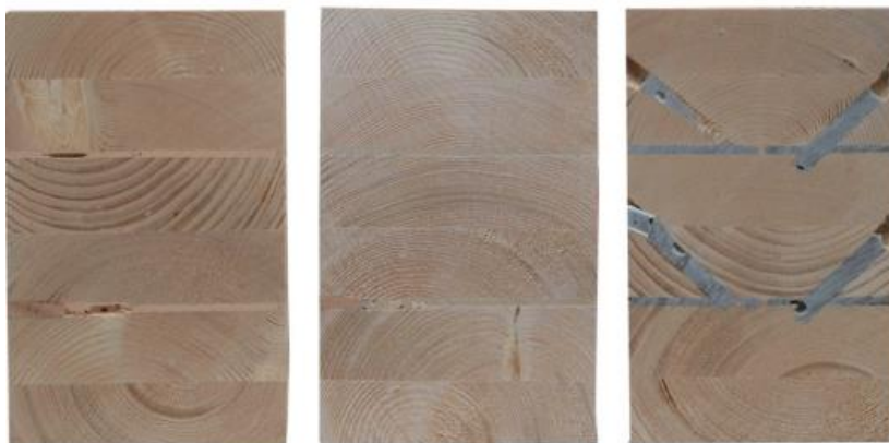
الشكل (4): نتيجة طرق الإصلاح المختلفة (الصب والحقن) لثلاثة من المواد اللاصقة، المرجع: (Franke et al., 2015)
