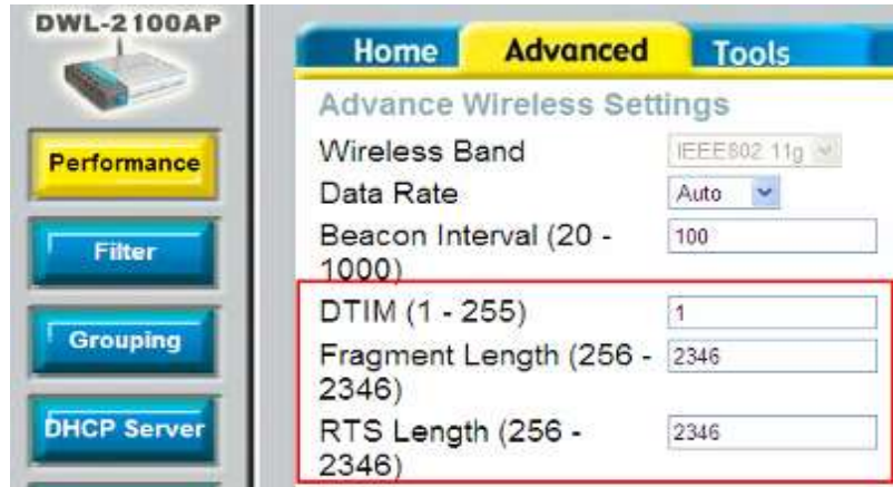
الشكل (16) التحكم بتجزئة المعطيات و الـ RTS لنقطة النفاذ المستخدمة
