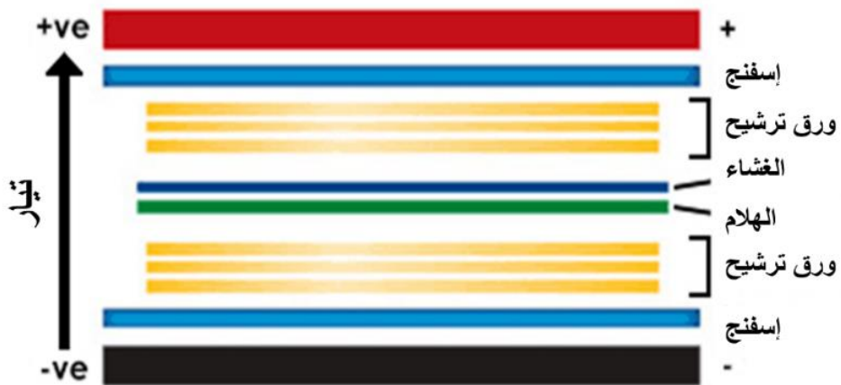
الشكل 6: توضح كيفية ترتيب الطبقات لعملية نقل البروتين من الهلام الى الغشاء
