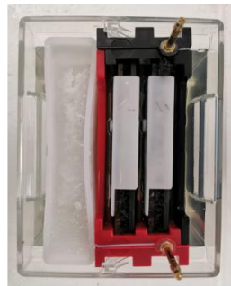
وضع الطبقات في الحامل المخصص مع وحدة التبريد في الوعاء
