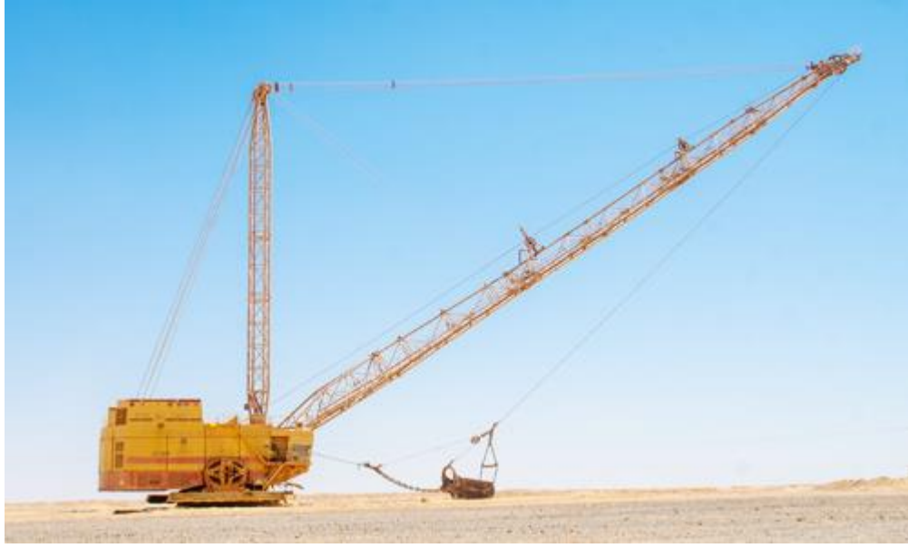
الشكل (5) غارفة عملاقة ( DRAGLINE )
